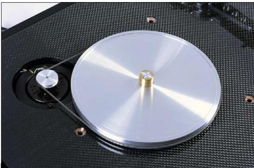
**DREHZAHN HALTEN:** Mittels Rundriemen treibt der metallene Motorpulley den Subteller an. Den eigentlichen Teller zentriert der mittige Zylinder mit Bronze-Außenhaut. In den drei Bohrlöchern versinken im Transportfall die Sicherungsschrauben.
