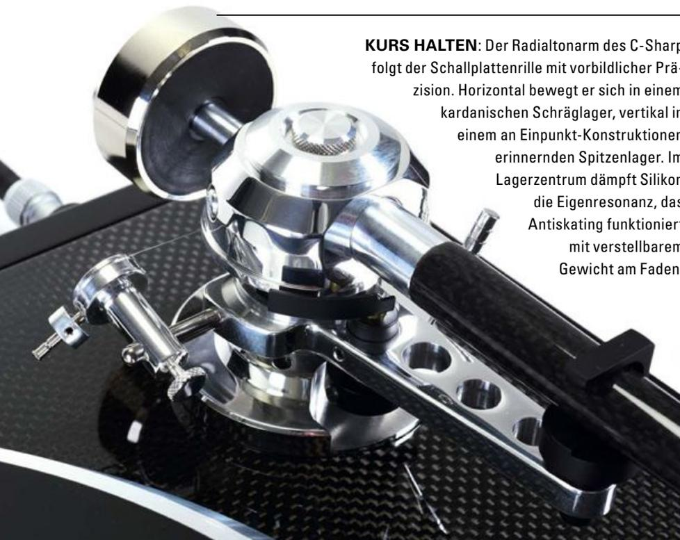
**KURS HALTEN:** Der Radialtonarm des C-Sharp folgt der Schallplattenrinne mit vorbildlicher Präzision. Horizontal bewegt er sich in einem kardanischen Schräglager, vertikal in einem an Einpunkt-Konstruktionen erinnernden Spitzenlager. Im Lagerzentrum dämpft Silikon die Eigenresonanz, das Antiskating funktioniert mit verstellbarem Gewicht am Faden.
